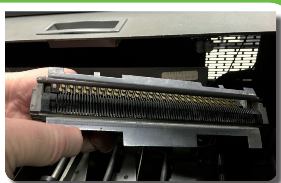
Spazzole di lettura di una IBM 1402 (29.1)
